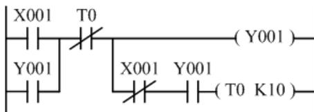
418. 如圖所示之階梯圖為？ (A)自保持 (B)互鎖 (C)交替 (D)單擊 電路。
