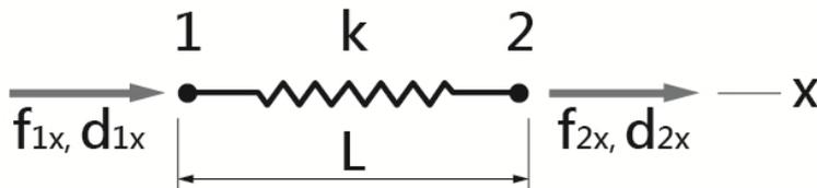
256. 在 X-Y 平面座標上，稱為 global coordinates，一個彈簧位於與 X 軸成  $30^\circ$ ；CCW(counter clockwise)軸上，可在彈簧軸向設立一座標系，稱為 local coordinates，這二個座標系統
