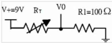
300. 一根  $100\ \Omega$  的白金電阻溫度檢測器(resistance temperature detector RTD)被使用於系統內。目前電阻讀取值是  $110\ \Omega$ 。溫度係數  $0.39\ \Omega/^{\circ}\text{C}$ ，求此溫度為何？ (A)25 (B)25.6 (C)26 (D)26.5  $^{\circ}\text{C}$ 。
