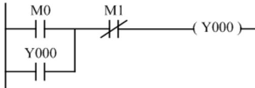
419. 如圖所示之階梯圖，M1 功能為？ (A)啟動自保持 (B)解除自保持 (C)交替 (D)單擊 電路。
